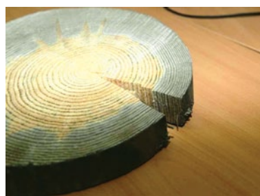
Поперечный распил опоры для проверки пропитки
